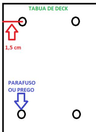
Fixar as tabuas com dois parafusos ou pregos (ver especificações do fabricante das ferragens) em todas bases de fixação, medindo da borda para dentro 1,5 centímetros, respeitando as medidas de 35 a 35 centímetros para tabua de 1,8 e de 45 a 45 centímetros para tabua de 2,2 com um espaçamento de 3 a 5 mm entre as tabuas.
